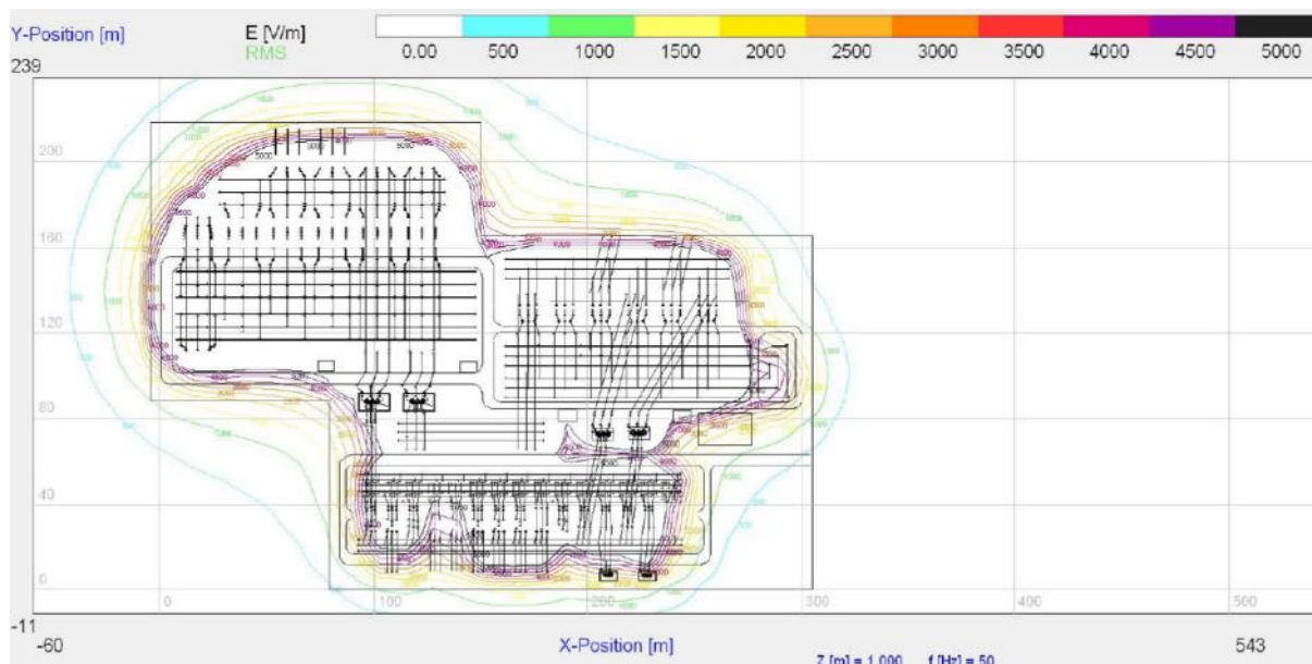
Slika 4.3-5 Izolinijski prikaz jakosti električnog polja na visini 1 m - dvodimenzionalni prikaz
