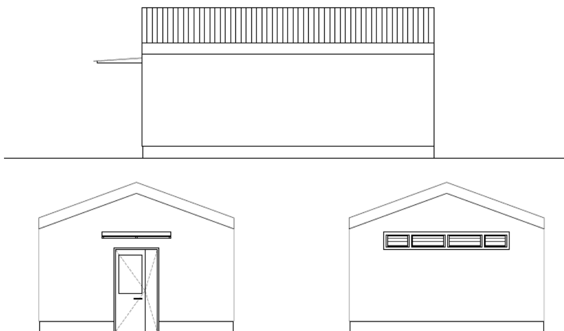
Slika 1.2-16 Prikaz pročelja relejne kućice 220kV rasklopišta
