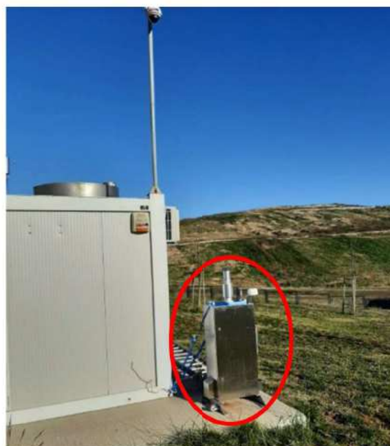
Slika 11. : Sekvencijalni uzorkivač na mjernom mjestu AMP Kaštijun
