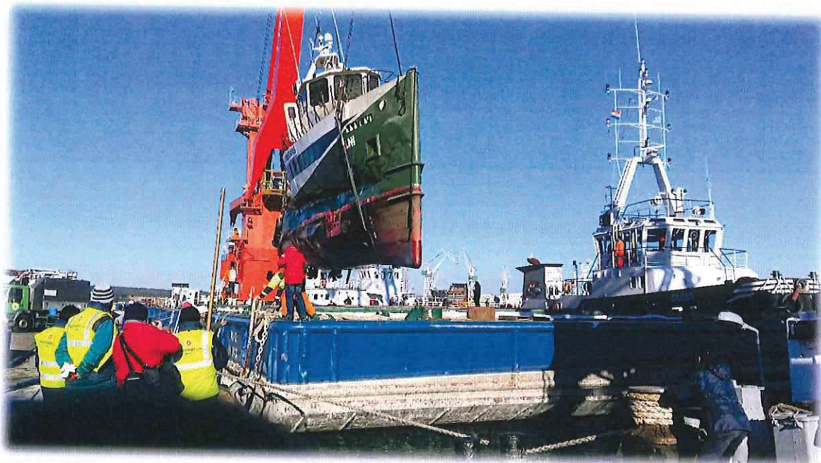
Slika 34. Polaganje podrtine m/b SILNI na teglenicu TEG 74
