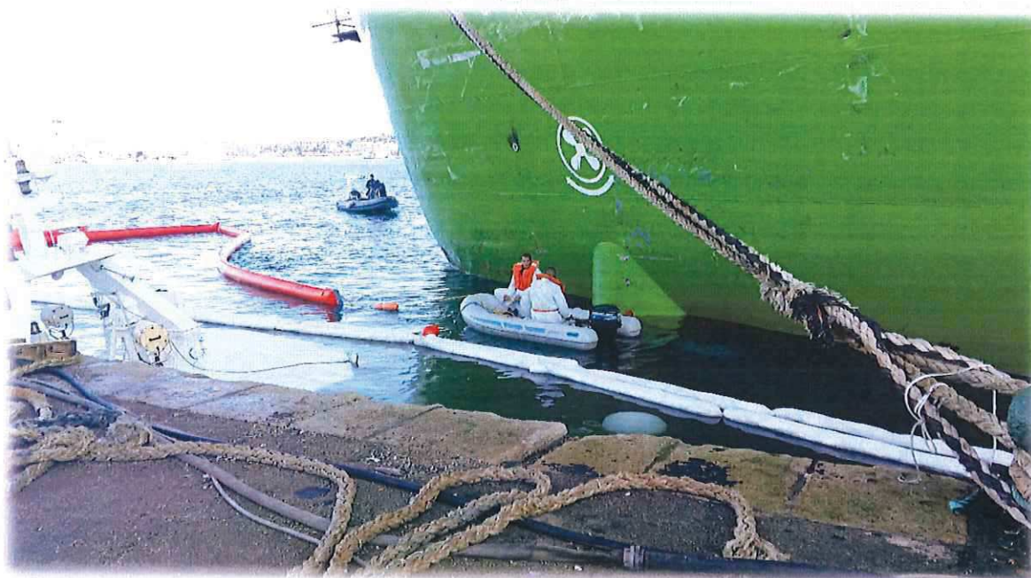
Slika 5. Postavljanje zaštitne plivajuće brane oko podrtine
