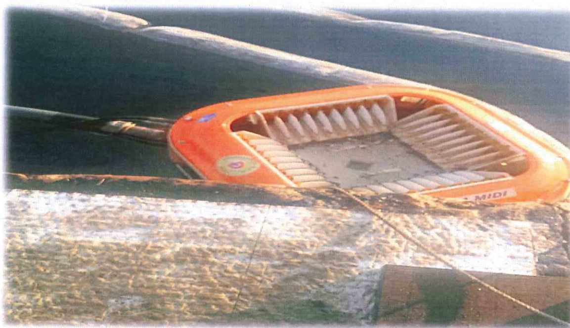
Slika 7. Prikupljanje ulja uz pomoć skimer uređaja
