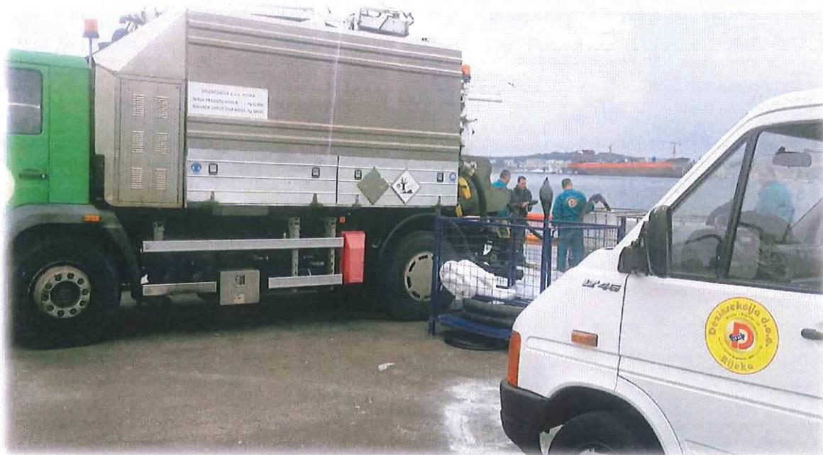
Slika 14. Preuzimanje tekućeg otpada – vacuum cisternom
