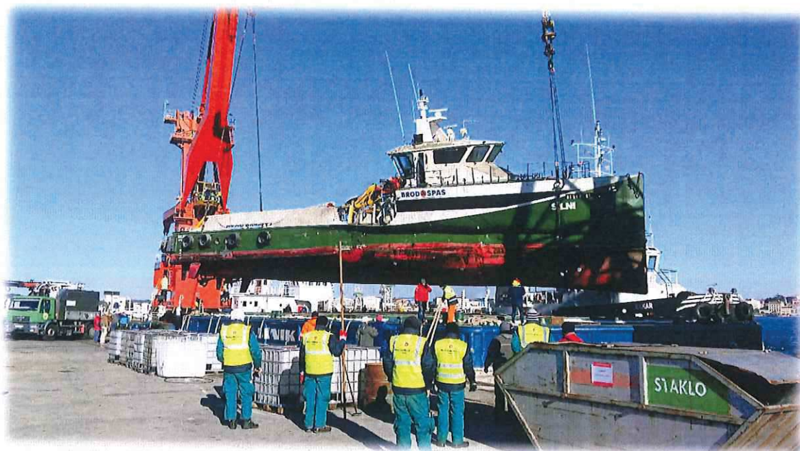
Slika 33. Polaganje podrtine m/b SILNI na teglenicu TEG 74
