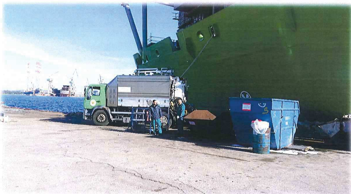
Slika 15. Preuzimanje tekućeg otpada – vacuum cisternom
