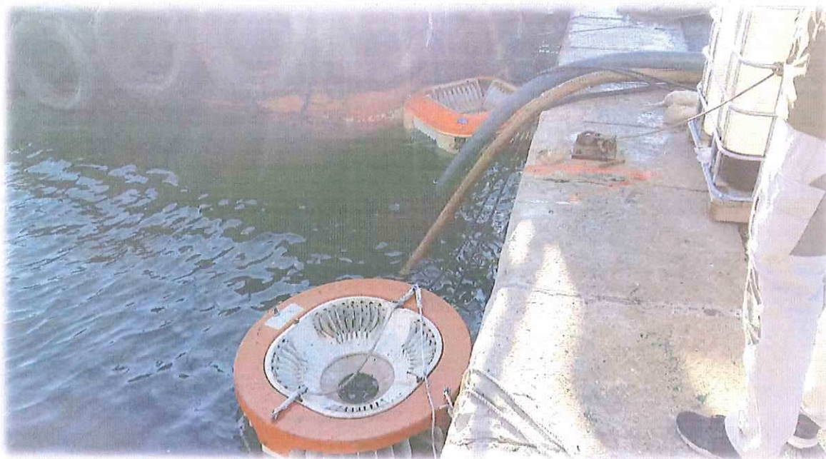
Slika 29. Prikupljanje ulja skimer uređajima
