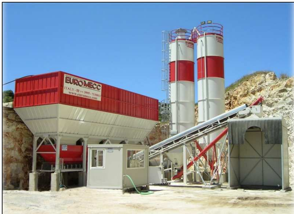
Slika br. 1.: Betonara tipa 6 – TRP – 30 – 1500 – S, proizvođača EURO MECC
