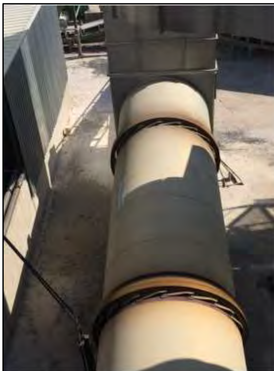
Slika 9: Bubanji za sušenje agregata
