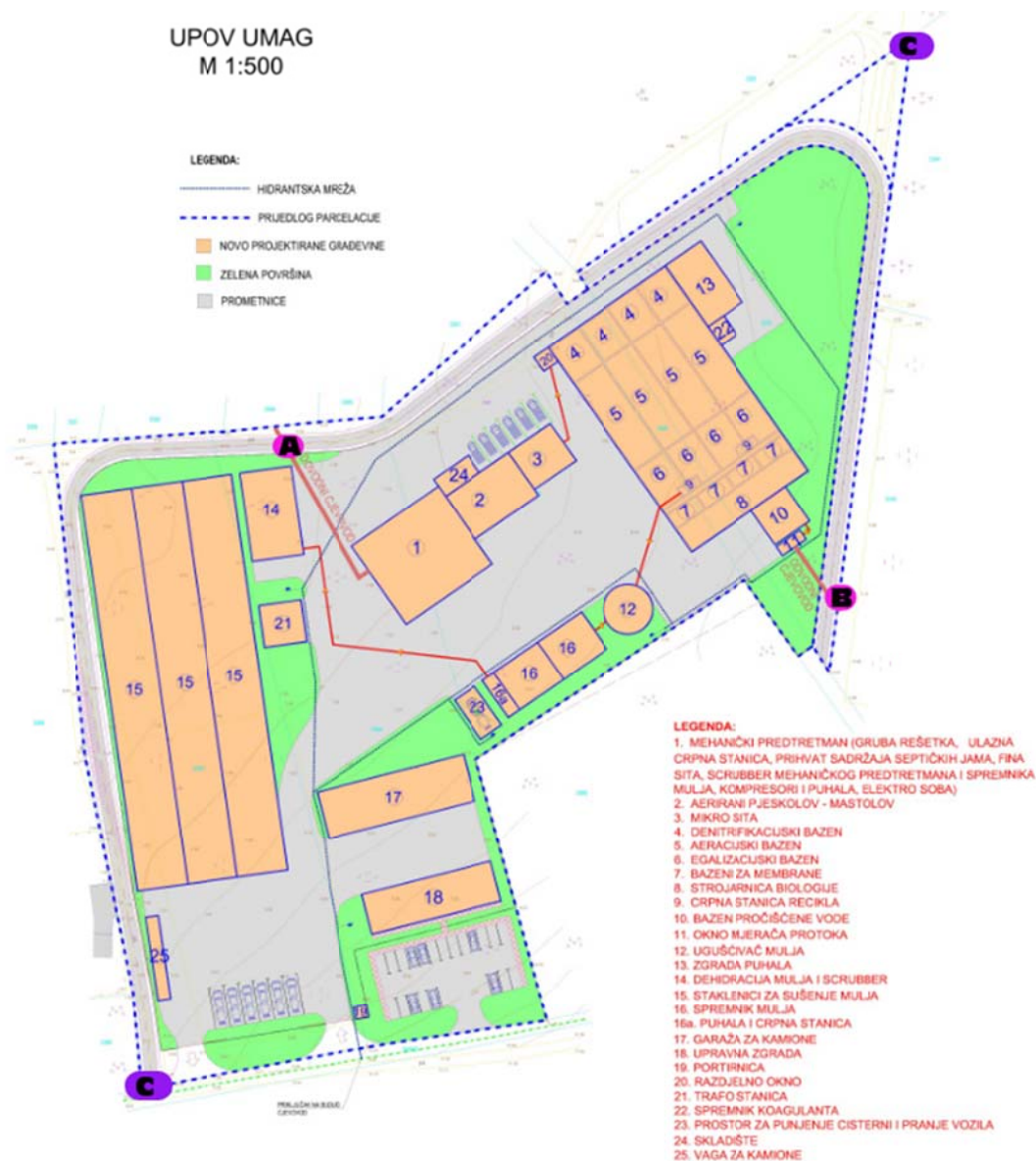
Slika 6.1. Lokacije na kojima je potrebno provoditi praćenje stupnja pročišćavanja (lokacija A – ulaz; lokacija B – izlaz), kvalitete zraka (C) te buke (C).
