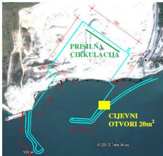
Slika 7.60. Konture varijantnog rješenja B marine Antenal sa naznakom predloženih pozicija cijevnih otvora u tijelu sekundarnog lukobrana i linijom prisilne cirkulacije (varijanta Bmod)
