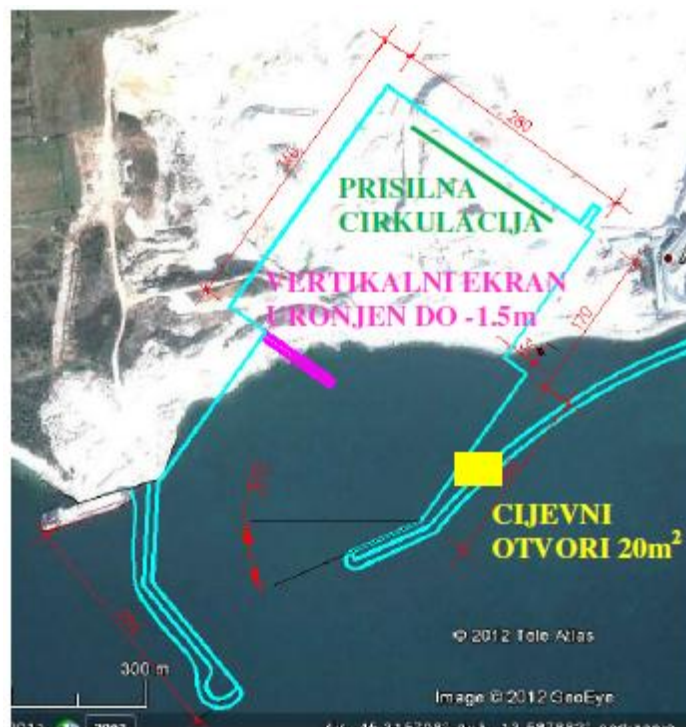
Slika 7.61. Konture varijantnog rješenja C marine Antenal sa naznakom predloženih pozicija cijevnih otvora u tijelu sekundarnog lukobrana i linijom prisilne cirkulacije (varijanta C)
