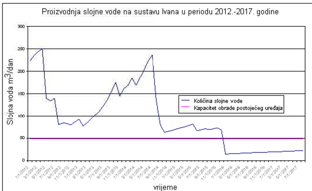
Slika 14. Projekcija proizvodnje slojne vode na sustavu Ivana A (platforme Ivana A, B, C, D i E, Ana i Vesna) (izvor: INA d.d.)
