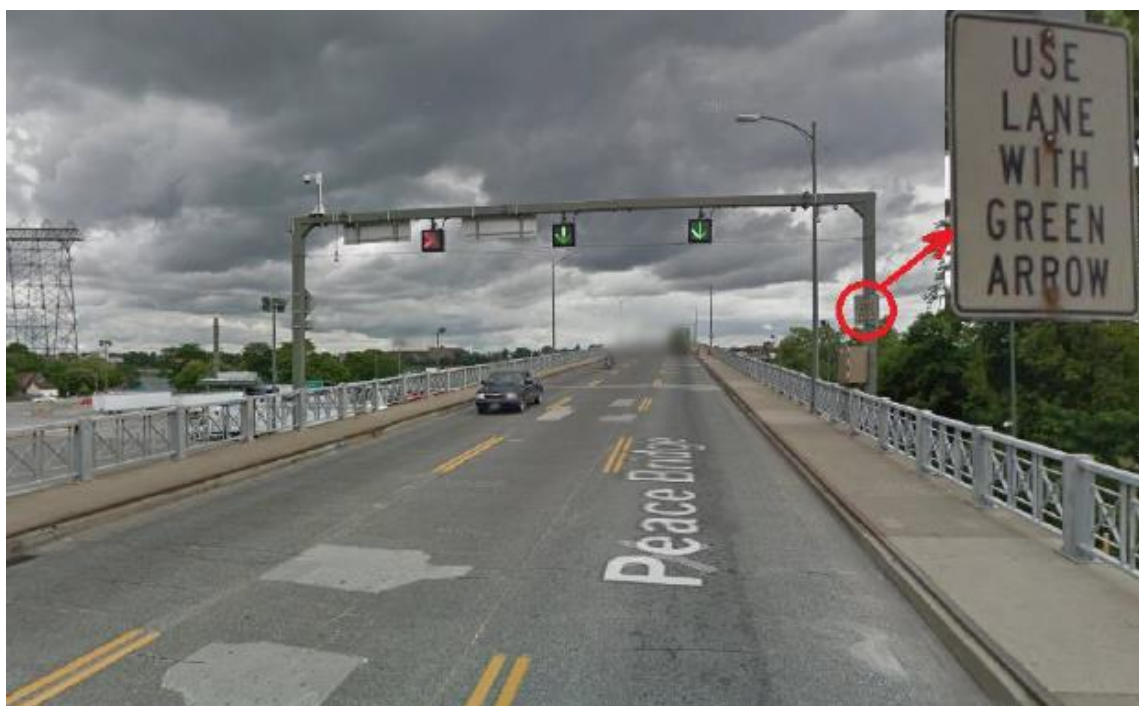
Slika 77. Prikaz mogućnosti korištenja svjetlosne signalizacije za promjenjivo usmjerenje prometnih traka
